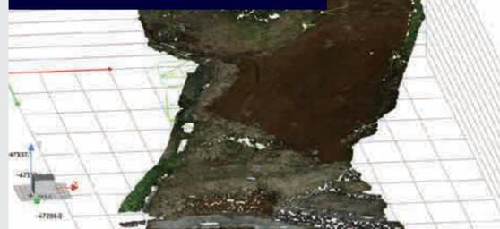
STEP1で取り込んだデータを基に、3次元点群データを作成します。
